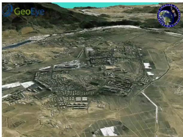
Figura 4: Imagem Stereo Ikonos de resolução espacial de 1m e modelo digital de superfície de 2m.
